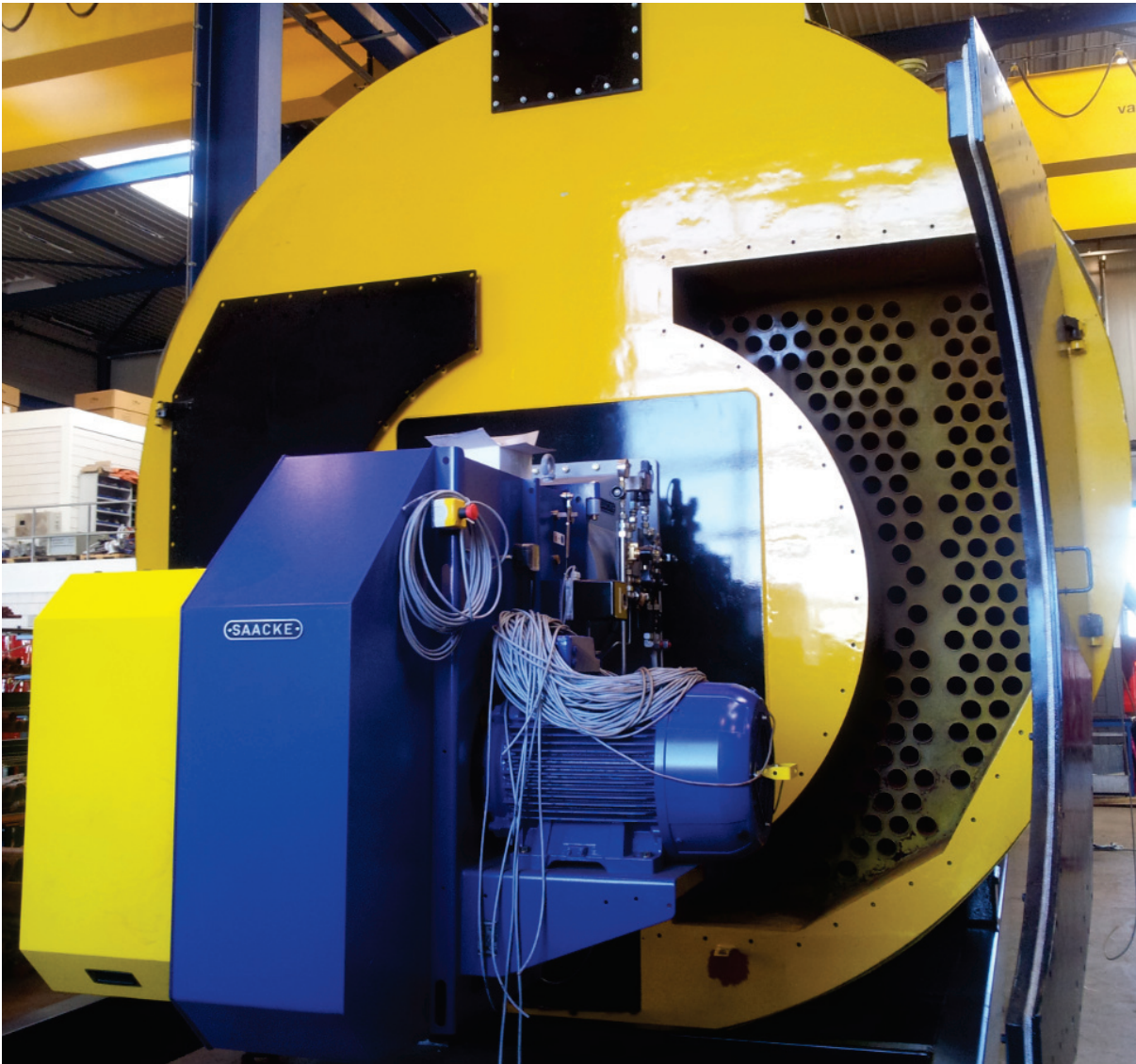
Figuur 6.1: Een gloednieuwe vlampijpketel met geopende keerkast
